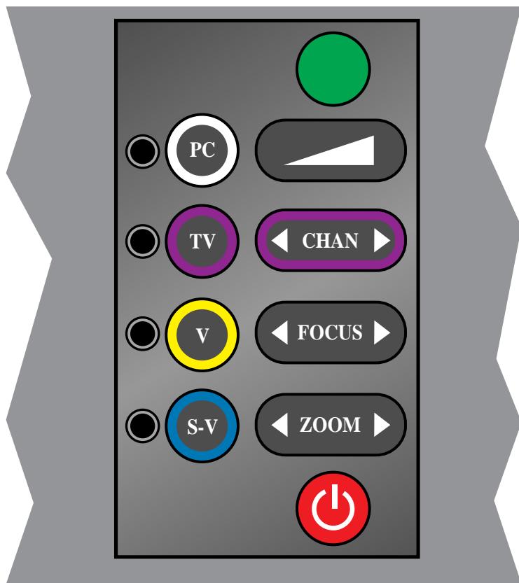
Figura 14: I tasti sul pannello a sfioramento sul proiettore KODAK DP850 ULTRA
